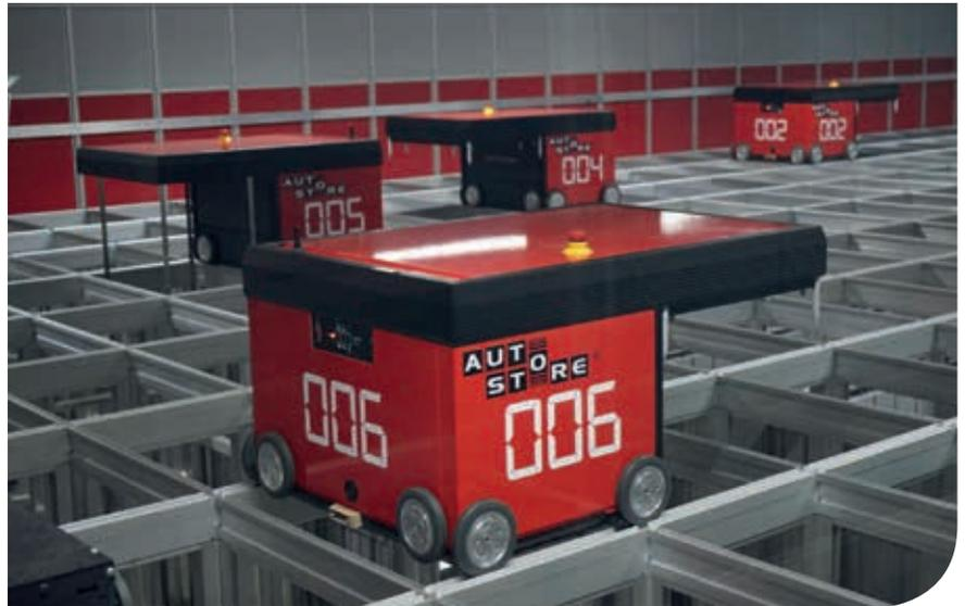
*Innovatives Highlight:* Im Kommissionierautomaten stellen programmgesteuerte Roboter selbständig Warenpakete zusammen.
